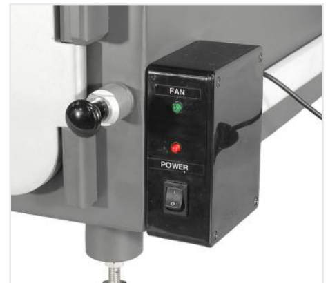
Fan indicator lights
