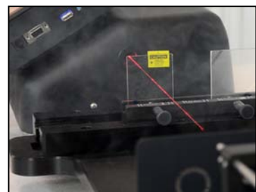
激光光束 (测试必须在暗房进行)。
