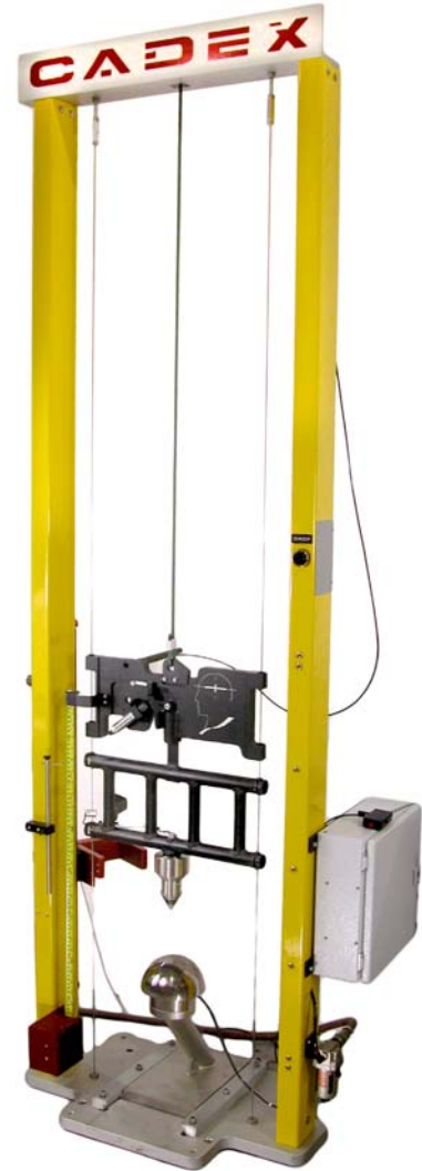
左图：标准基座可安装用于不同测试的附件。 (图示是澳洲力的分布测试附件)
