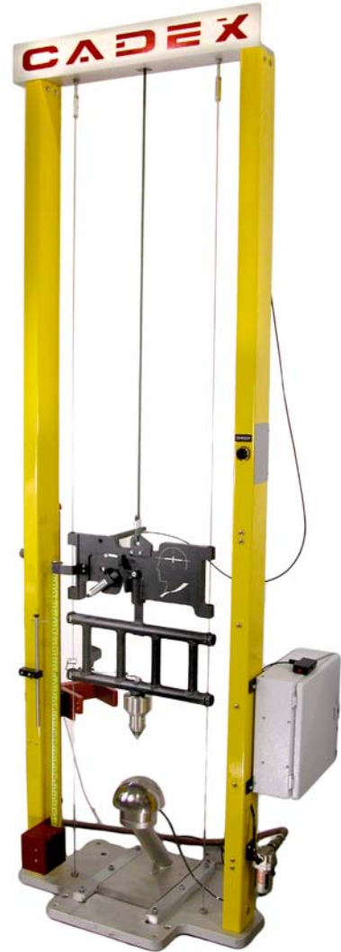
左图：标准基座可安装用于不同测试的附件。 (图示是澳洲力的分布测试附件)
