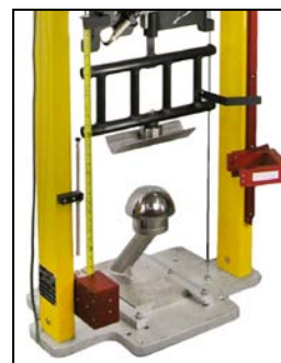
左图：标准基座可安装用于不同测试的附件。 (图示是澳洲力的分布测试附件)
