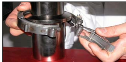
独有的快拆装置可大大节省安装固定时间
