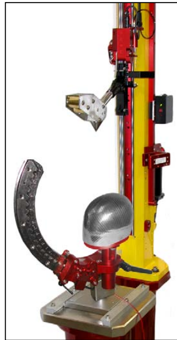
单轨撞击机上穿刺测试装置示意图.
