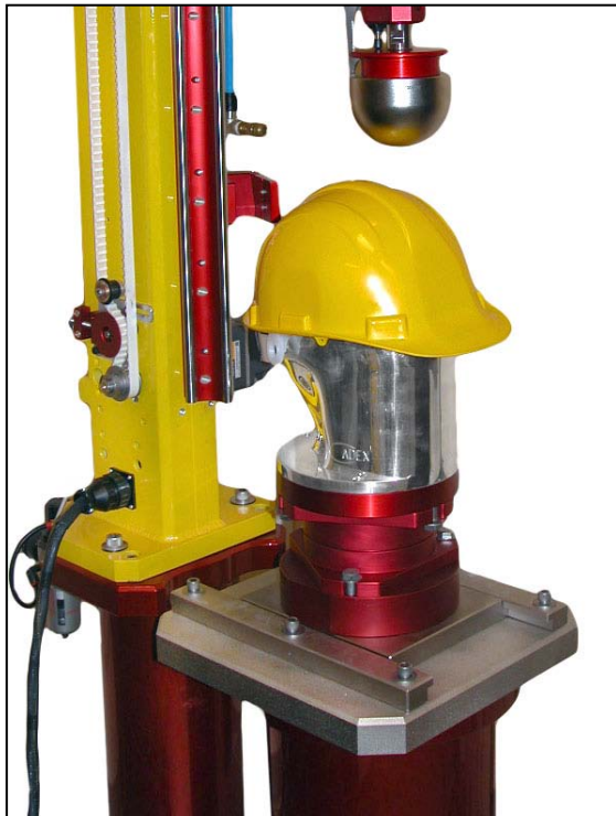
安装在单轨撞击机上示意图
