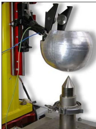
单轨撞击机上安装示意图。
