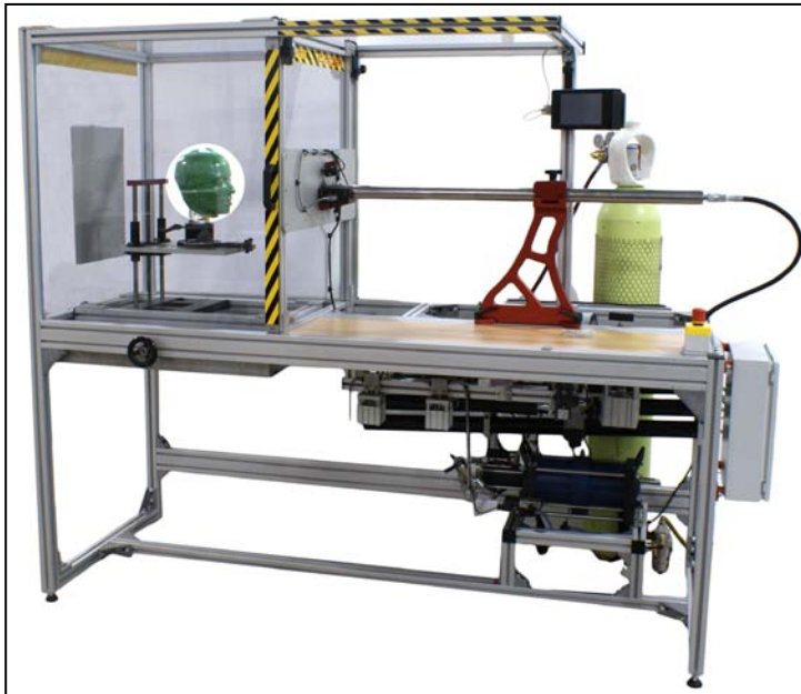
安装在高压气枪检测设备上示意图
