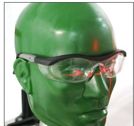
奥尔德森头模在护目镜测试中示意图。 (头模表面也可为绿色)
